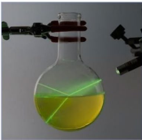
Doc. 5. À la surface de l'eau, une partie du rayon est réfléchi et l'autre est réfracté.
